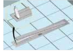
Kapak anahtarının yardımıyla sifonu temizleyiniz.
