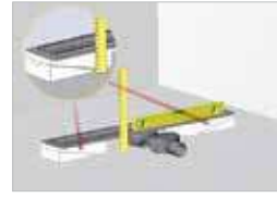
Yükseklik ayar setini zemin kotuna göre terazi ile ayarlayınız. Her kademe 2 mm'dir.
