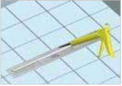
Silikon ya da derz ile metal çerçeveyi sabitleyiniz.
