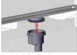
Sifon gövdeye bağlanmış olmalı
