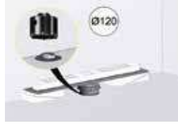
Boru bağlantısı için beton çukurdek matkap yardımıyla delin
